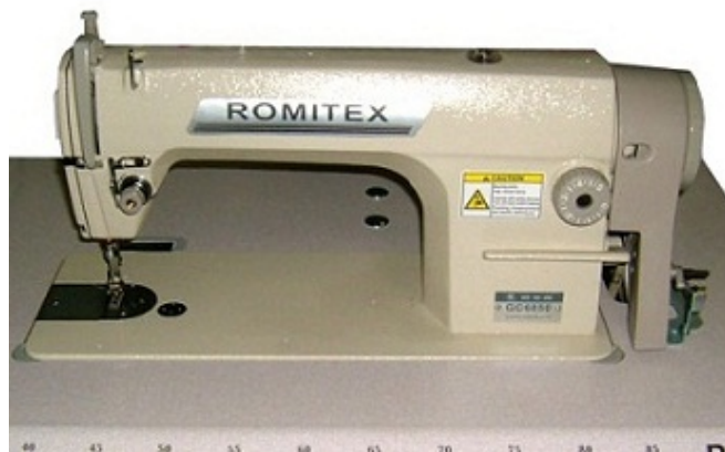
8. ábra. Egyfonalas lengőkampós láncöltésű varrógép 8
