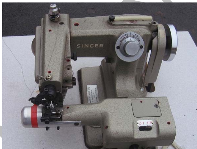
5. ábra. Karos rejtet töltésű varrógép 5
