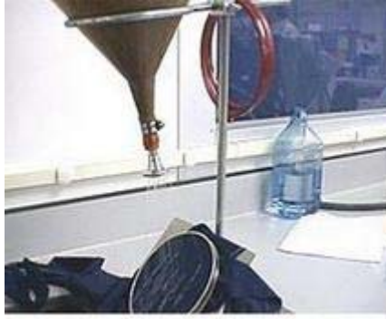
19. ábra. Esőztető készülék 5
