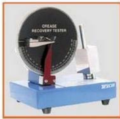
17. ábra. Gyűrődés feloldódási szög mérésére alkalmas berendezés 3
