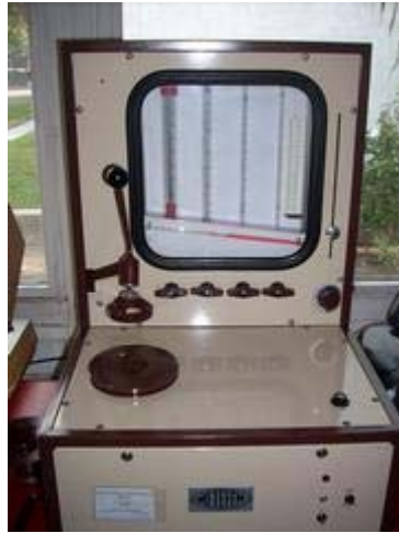
18. ábra. Légáteresztést mérő készülék 4
