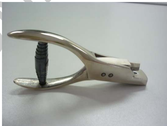
6. ábra Becsípés jelölő eszköz
