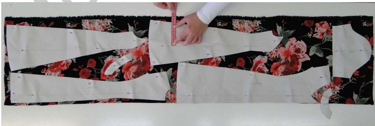
4. ábra. Szabásminták rögzítése
