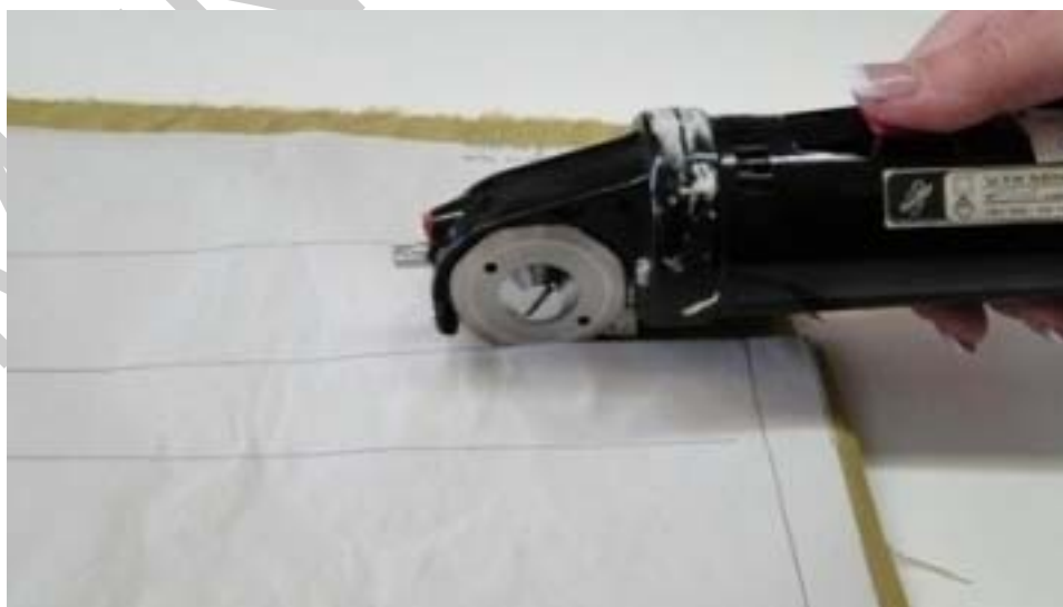
11. ábra. Alkatrészek szabása körkéses szabásgéppel
