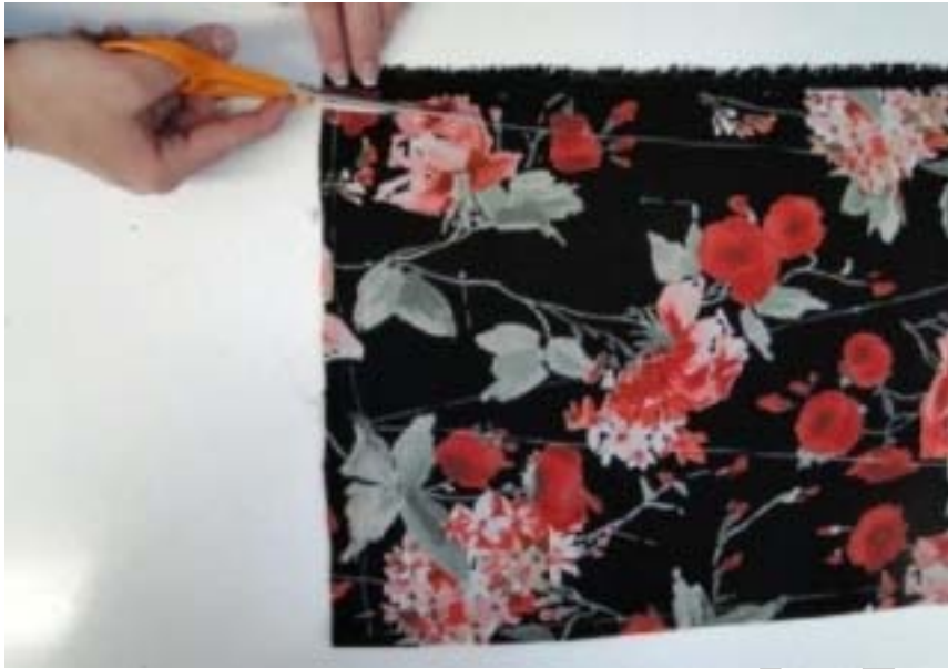
7. ábra. Alkatrészek kivágása szabászollóval
