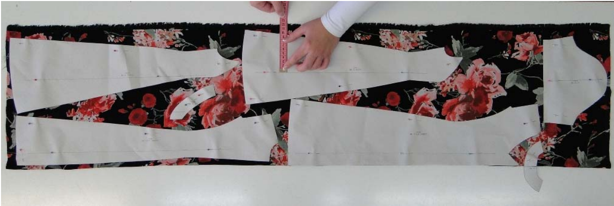
13. ábra. Női ruha szabásmintáinak felfektetése
