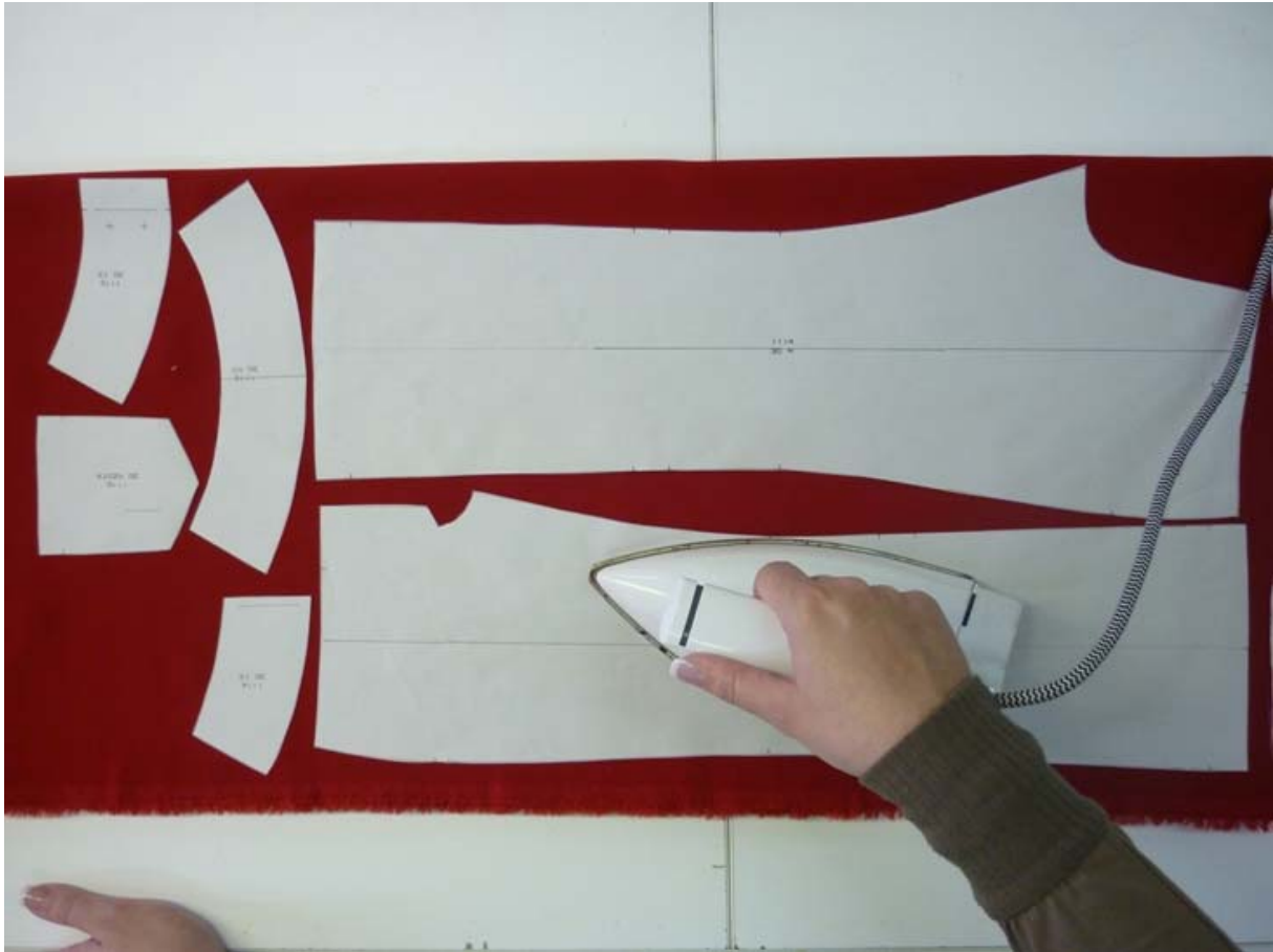
21. ábra. Szabásminták hővel történő rögzítése
